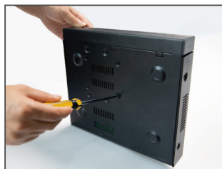
3. Posizionare e fissare il disco rigido
