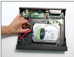
5. Collegare il cavo di alimentazione
