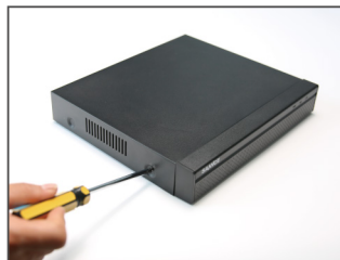
1. Entfernen Sie die Schraube
