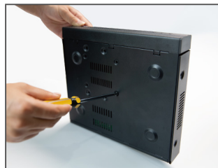
3. Setzen Sie die Festplatte ein und befestigen Sie sie
