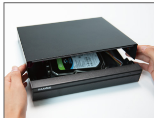
6. Setzen Sie die Abdeckung auf
