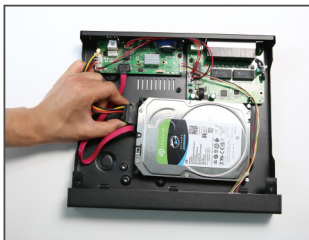
5. Schließen Sie das Stromkabel an
