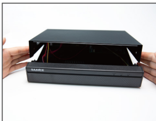
2. Entfernen Sie die Abdeckung
