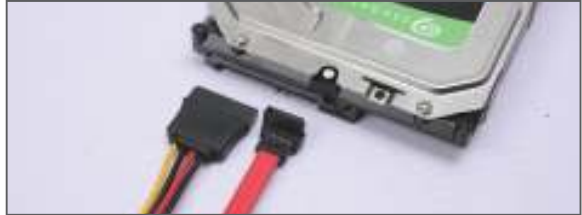
◀ Verbinden Sie das Datenkabel und das Stromkabel mit dem entsprechenden Port der Festplatte.
